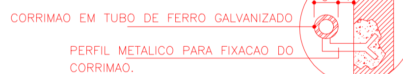
DETALHE DO CORRIMÃO
