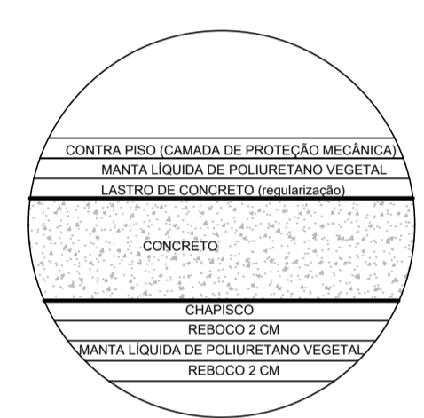
DETALHE 03 DO TETO (IMPERMEABILIZAÇÃO) Sem escala
